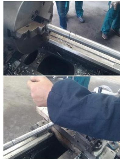
2013.4.12, 咸宁市某公司员工周某, 在加工长轴时, 护袖被工件上貌似钩住, 右手臂被卷入工件, 左手及时停车, 造成右臂骨折。
